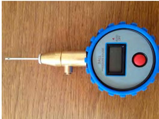
Abbildung 5: Digitaler Ballluftdruckprüfer
